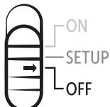
⚠️ **ATENCIÓN:** Para las acciones siguientes, la cámara debe estar desconectada (control deslizante 13 = posición OFF). De lo contrario pueden producirse daños en la cámara.
